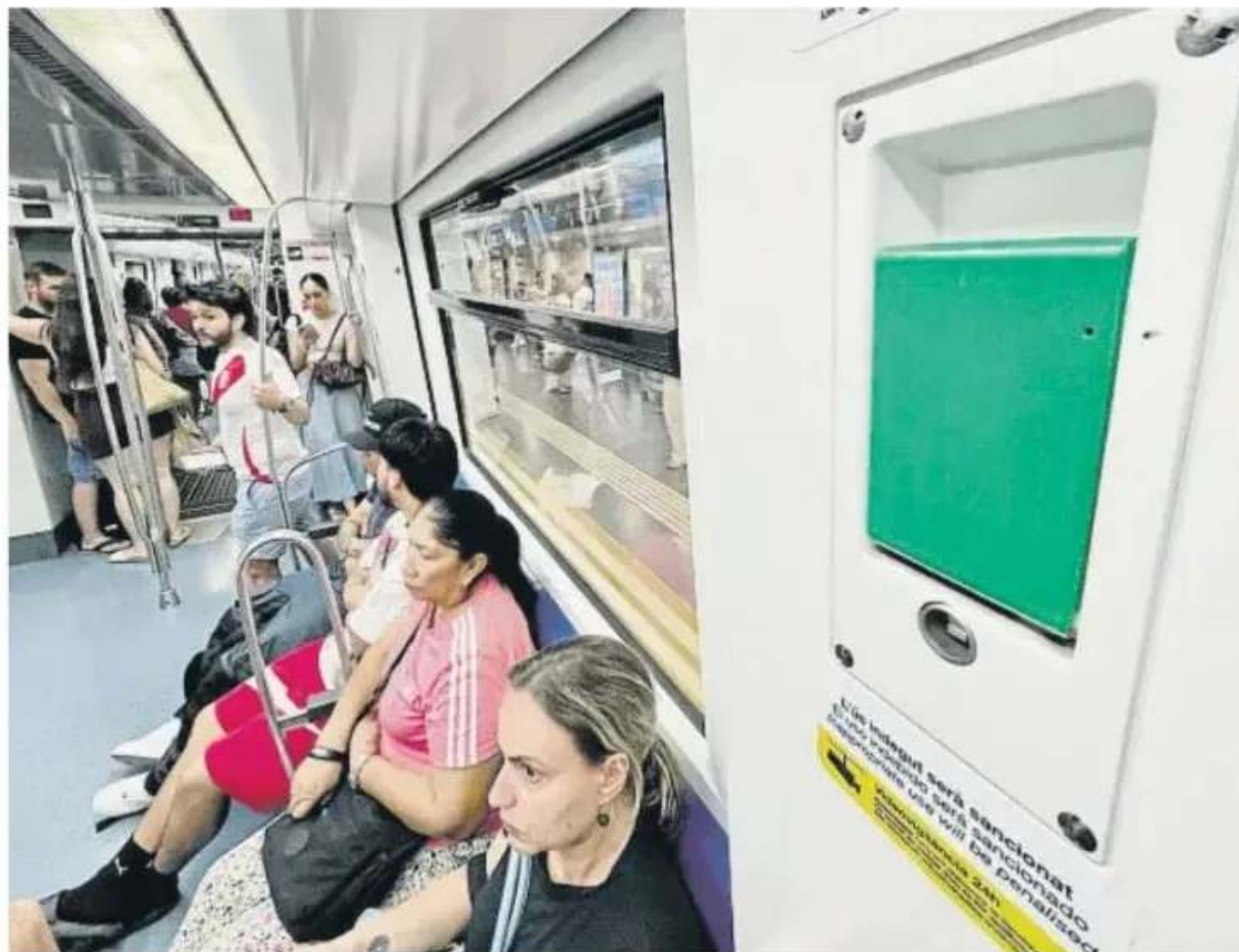
La manilla verde es el sistema que permite abrir las puertas en caso de emergencia en el metro
